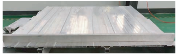
(b) 采用SDS-FSW焊接 (正反面同时FSW→打磨飞边)
